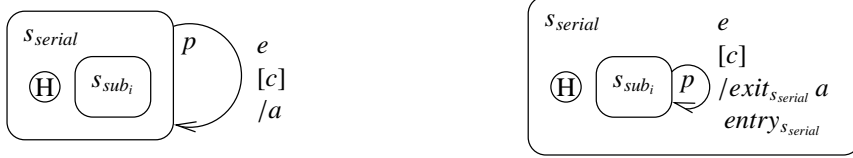
Abbildung 4.29: Flattening-Regel für eine Transition des Typs (s_{serial}, l_T, s_{serial}), s_{serial} \in \Sigma_{his}
