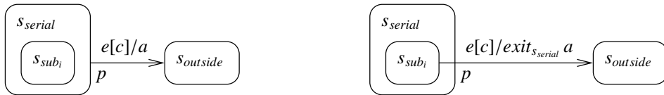
Abbildung 4.30: Flattening-Regel für eine Transition des Typs (s_{serial}, l_T, s_{outside})
