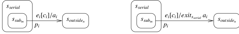
Abbildung 4.26: Flattening-Regel für eine Transition des Typs (s_{sub}, l_T, s_{outside})
