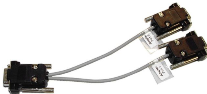
Abbildung A.21: Kabelpeitsche für Leistungselektronik
