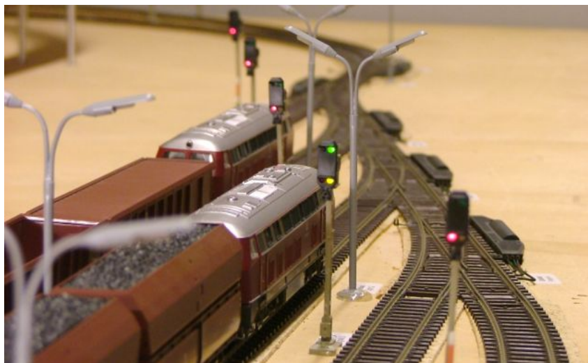
Abbildung 2.16: Hauptsignale am Ausgang eines Bahnhofes
