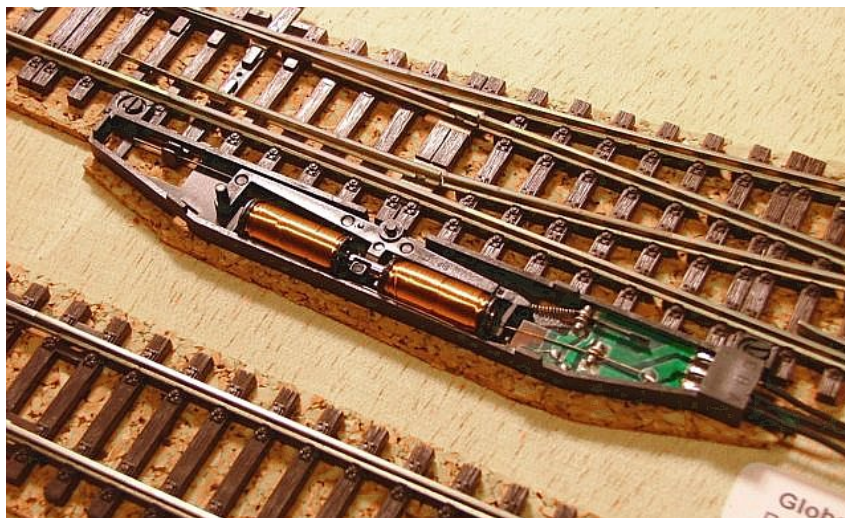
Abbildung 2.12: Elektrischer Antrieb an einer Weiche
