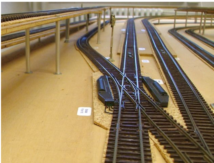
Abbildung 6.3: Eine der beiden Kreuzungsweichen
