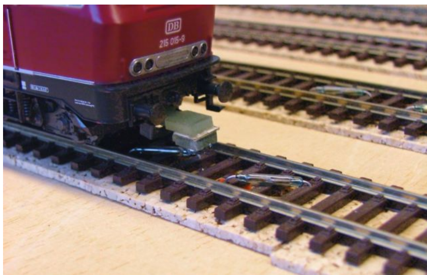
Abbildung 2.15: Auslösen eines Kontaktes durch eine Lokomotive
