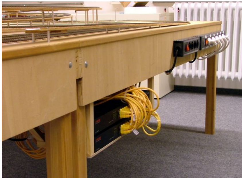
Abbildung 4.4: Ethernet-Switches und Hauptschalter am Rand der Bahn
