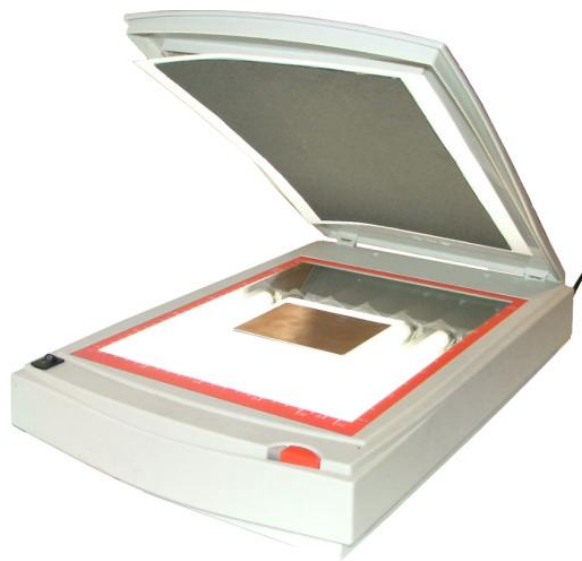
Abbildung D.7: Belichter aus Leuchtstoffröhren in einem Scannergehäuse
