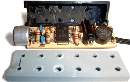
Abbildung A.7: Einbau des Mindstorms Schallsensors in einen Legostein
