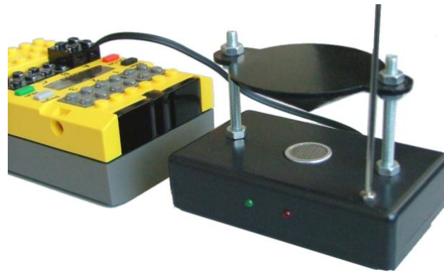
Abbildung A.40: RCX-basierender Sender für das Ortungssystem
