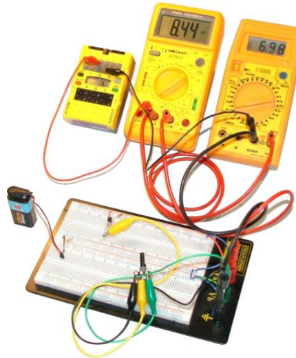
Abbildung C.1: Belastungsmessung an einem Sensoreingang
