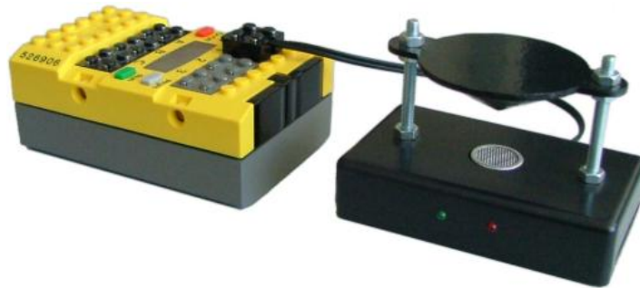
Abbildung A.43: RCX-basierender Empfänger für das Ortungssystem
