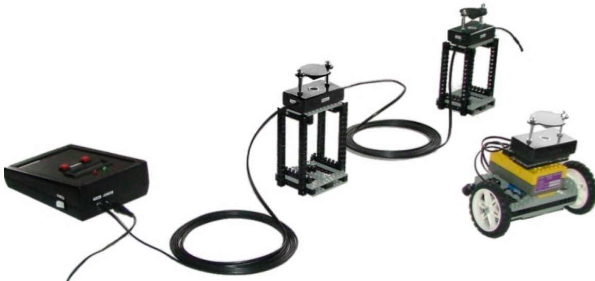
Abbildung 5.1: Minimalaufbau des Ortungssystems
