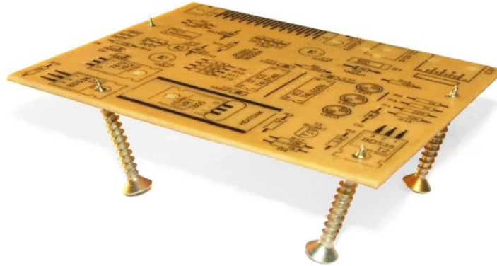
Abbildung D.14: Lackierte Platine, zum Trocknen aufgestellt
