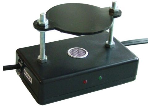
Abbildung A.35: Leuchtf Feuer für das Ortungssystem
