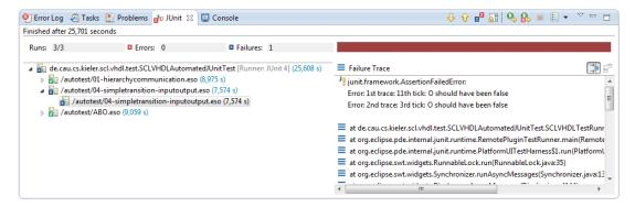
Abbildung 5.7. Ergebnisse eines Regressionstests
