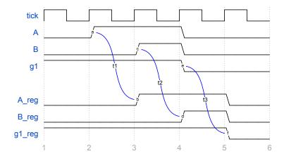
Abbildung 4.30. Tick Signal Diagramm — Wann werden Werte in Registern gespeichert
