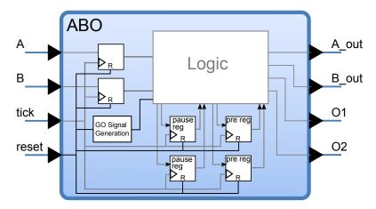
Abbildung 4.31. ABO Übersicht — mit Reset und GO Signal
