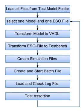
Abbildung 5.6. Die einzelnen Schritte des Regressionstests
