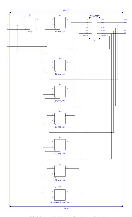
Abbildung 8.2. Hierarchischer Schaltplan von ABO
