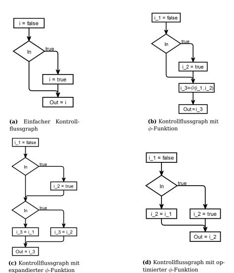
**Abbildung 4.18.** Die  $\phi$ -Funktion angewendet auf einen einfachen Kontrollflussgraphen mit Umsetzung und Optimierung der  $\phi$ -Funktion
