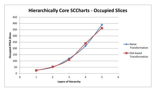
Abbildung 7.3. Evaluationsergebnis hierarchischer Core SCCharts — belegte Slices
