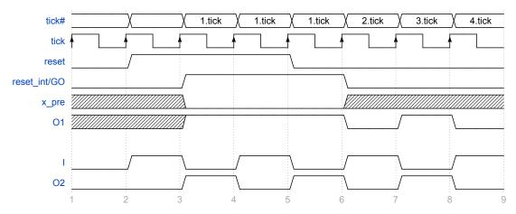
Abbildung 4.34. Signalverlauf der ersten Reset-Variante
