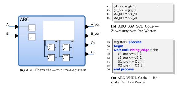
Abbildung 4.27. ABO — Generierung von Pre Registern
