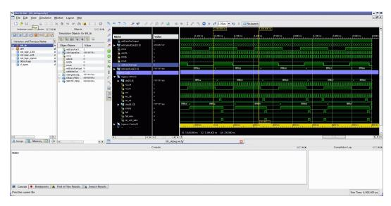
Abbildung 3.7. ISE-Simulator mit einem Signaldiagramm
