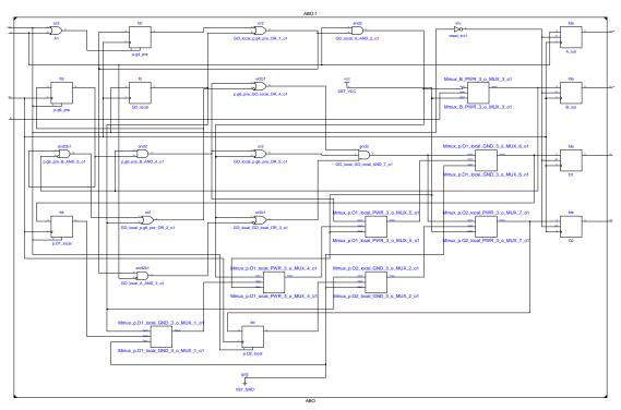
**Abbildung 4.15.** Synthetisierter Schaltkreis von ABO aus dem mit der naiven Transformation transformierten VHDL Code
