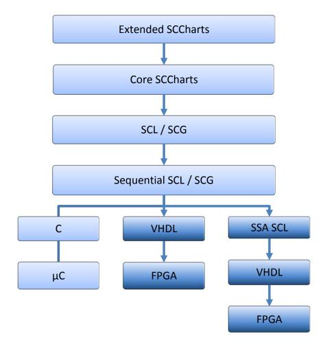
Abbildung 4.1. Transformationsschritte von extended SCCharts zu Hard- und Software
