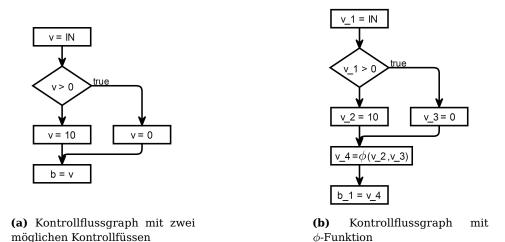
Abbildung 4.17. Die SSA -  $\phi$ -Funktion angewendet auf einen einfachen Kontrollfluss
