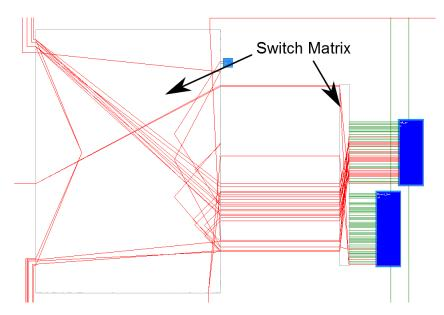
Abbildung 6.3. Sicht auf eine FPGA mit zwei gerouteten Slices
