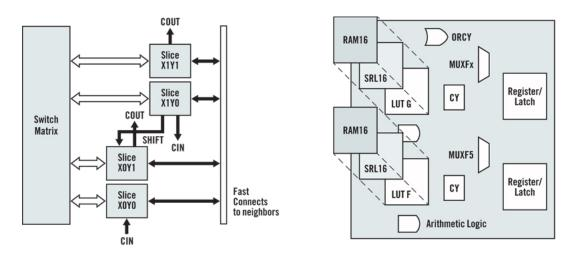
Abbildung 6.2. Struktur zweier CLBs (links) und einer Slice (rechts) [Inc13]
