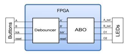
Abbildung 6.6. Übersicht der ABO Hardware Implementierung
