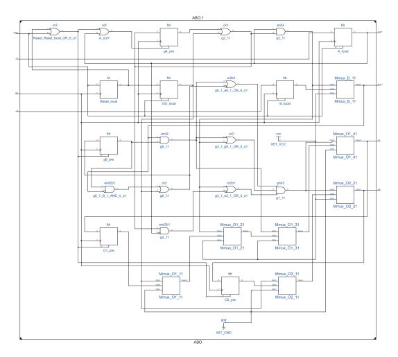
Abbildung 4.39. ABO Schaltplan generiert aus dem VHDL Code der SSA SCL Transformation
