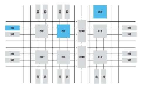
Abbildung 6.1. Block Struktur eines FPGAs [Inc13]
