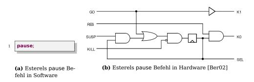
Abbildung 2.3. Der Esterel pause Befehl in Soft- und Hardware
