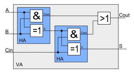
Abbildung 3.5. Komponenten Sicht eines 2 Bit Addierers
