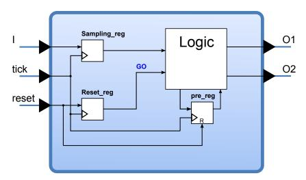
Abbildung 4.33. Schaltplan der ersten Reset-Variante
