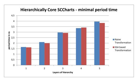
**Abbildung 7.4.** Evaluationsergebnis hierarchischer Core SCCharts — minimale Periodendauer
