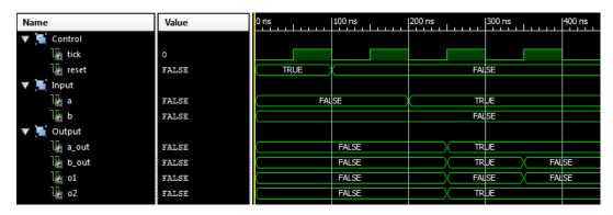
Abbildung 5.5. Signalverlauf von ABO im ISE Simulator
