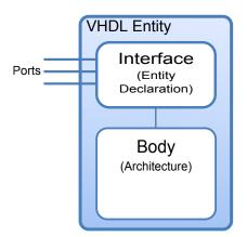
Abbildung 4.22. Struktur einer VHDL Entity
