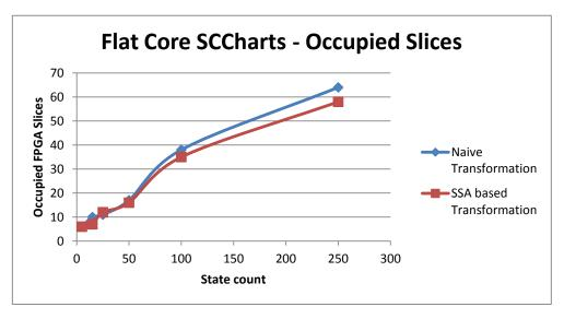
Abbildung 7.1. Evaluationsergebnis flacher Core SCCharts — belegte Slices
