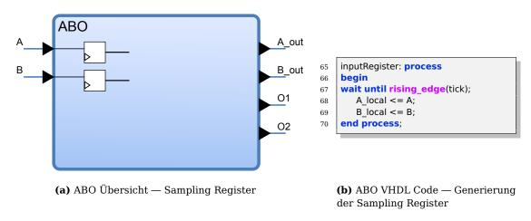
Abbildung 4.26. ABO - Generierung der Sampling Register
