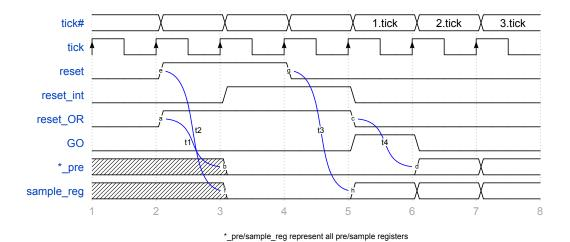
Abbildung 4.37. Signalverlauf der zweiten Reset-Variante mit GO- und Reset-Signal
