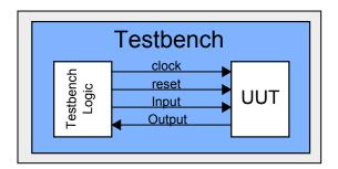
**Abbildung 3.6.** Abstrakte Sicht auf eine VHDL Testbench, mit Testbench Logik und dem *Unit Under Test*
